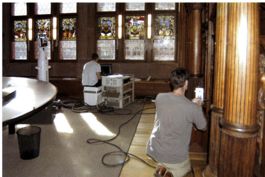
Abb. 6-5 Marktplatz 9 / Regierungsratsaal (2003/52). Die beiden Diplomanden bei der Digitalisierung des Renaissance-Portals. Links vor dem Fenster steht der Lasertracker, welcher Lage und Position des Handlasers verfolgt. Am Rechner lassen sich die Daten auf dem CAD darstellen und auf ihre Vollständigkeit überprüfen. – Foto: Basler Denkmalpflege.
