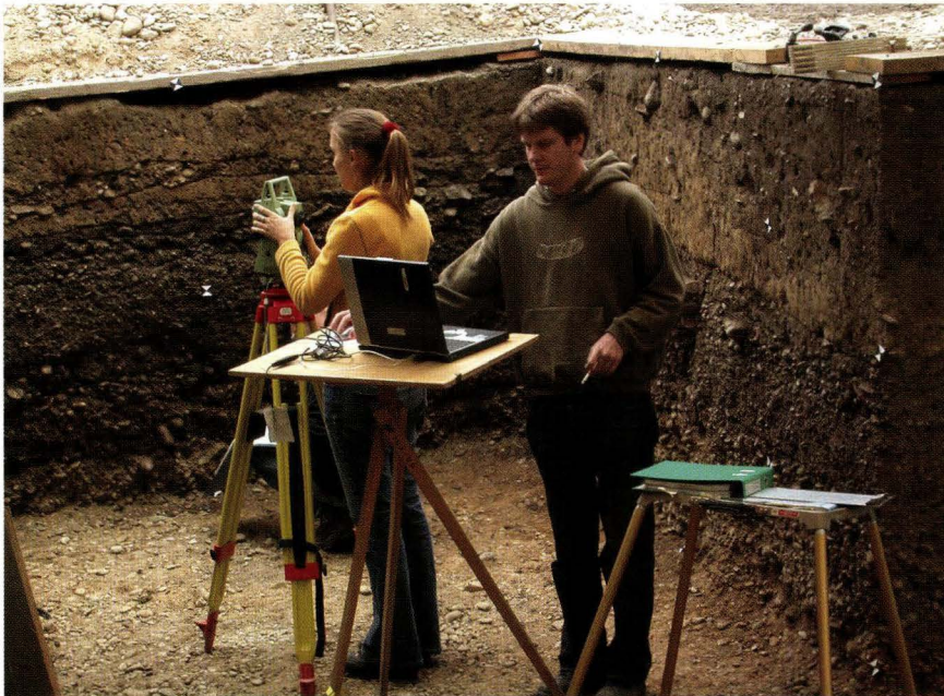
Abb. 5 Martinsgasse 6+8, 2004/1: Einsatz von Tachymeter und Notebook bei der Einmessung eines Profils. – Foto: Claude Spiess.
