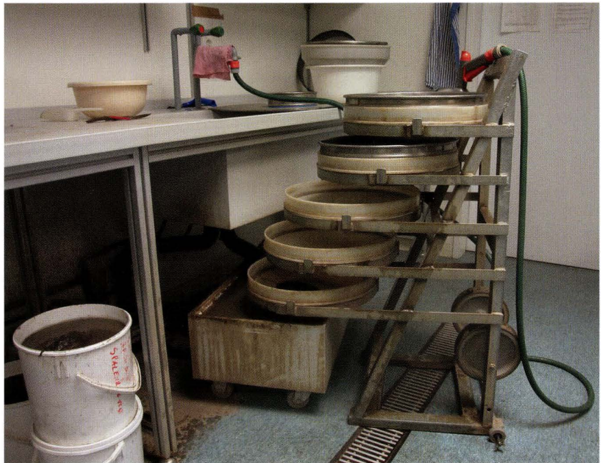
Abb. 9 Institut für Prähistorische und Naturwissenschaftliche Archäologie, Basel: Schlammvorrichtung für Bodenproben mit einer Abfolge von immer feinmaschigeren Sieben zum Auftrennen der verschiedenen Fraktionen. – Foto: Christian Stegmüller.
