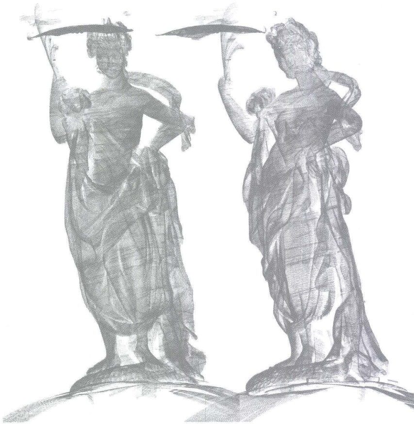
Abb. 6-6 Marktplatz 9 / Regierungsratssaal (2003/52). Hier zu sehen: das transparent und unstofflich wirkende Punktwolken-Bild der vollplastischen weiblichen Figur auf der Bedachung des Portals und des davor an die Decke montierten Wappenschildes. – Bild: Basler Denkmalpflege. Software: Point-Cloud von kubit.
