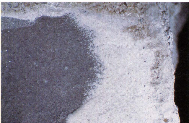
Abb. 83 Unvollständig gebrannter Kalkstein aus dem Mauer- mörtel der Inneren Stadtmauer. Grauer Muschelkalk der Trias mit weissem Saum aus Branntkalk. Bildbreite 1,6 cm. – Foto: Philippe Rentzel.
