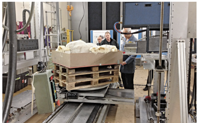
Abb. 33 Bei der Empa in Dübendorf: das Fundensemble liegt auf dem in alle Richtungen beweglichen Messtisch und wird zwischen Strahlenquelle und Detektor des Hochleistungs-Computertomographen bewegt. Während der Aufnahme darf niemand im Raum sein. Foto: Norbert Spichtig.
